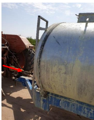
شکل ۳- استفاده از همزن مکانیکی قوی جهت تعلیق گوگرد در آب مخزن
