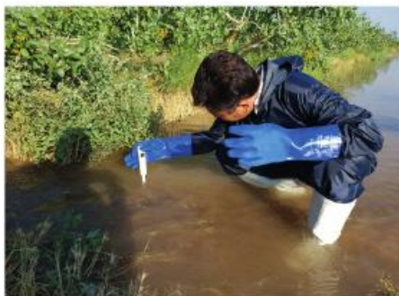
شکل ۷ اندازه‌گیری pH در آب آبیاری باغ‌های پسته
