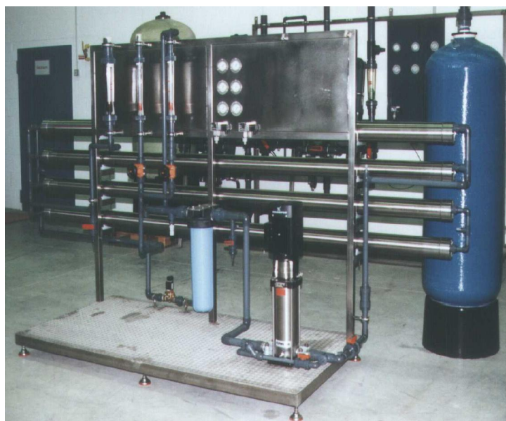
شکل ۲: آب شیرین کن اسمز معکوس با حجم تولید ۷۵ متر مکعب آب شیرین در روز
