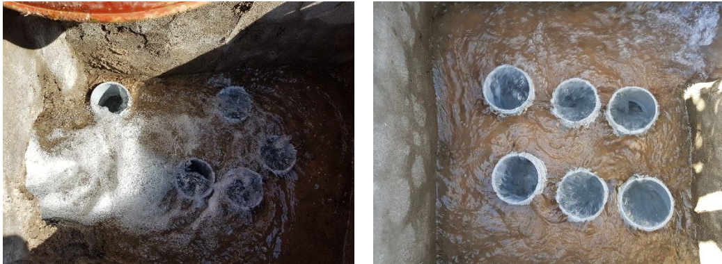
شکل ۱۲- تاثیر نحوه استقرار لوله‌ها بر وضعیت آبیاری آن‌ها در داخل حوضچه‌ها
